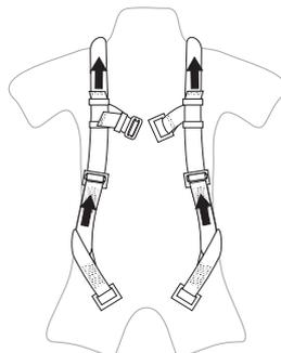
Ajuste cada una de las correas de los hombros (1) halando o soltando el extremo suelto, de modo que la correa subpélvica (8) quede colocada firmemente bajo los glúteos.
