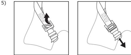
Ajuste la tensión de las correas de los muslos (5) halando o soltando el extremo suelto de la correa. Aparte el pasador de plástico del borde de la hebilla para facilitar el ajuste. Para las hebillas de lengüeta, seleccione el ojal deseado y asegure el exceso de cinta debajo del pasador de plástico. La tensión correcta se obtiene a un espacio de 2 dedos entre la correa y la pierna.
